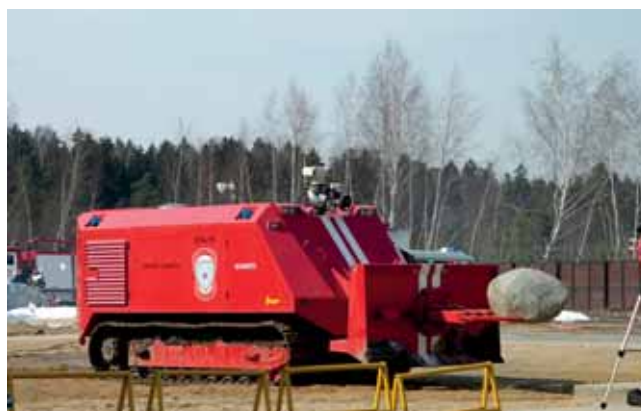
▲ Противопожарный робототехнический комплекс тяжелого класса «Ель-10» для работы в зонах повышенных температур и фугасно-осколочного поражения
