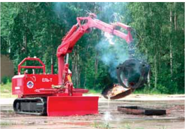
▲ Робототехнический комплекс для ликвидации техногенных аварий в условиях повышенной радиации, химической зараженности местности и т.д.
